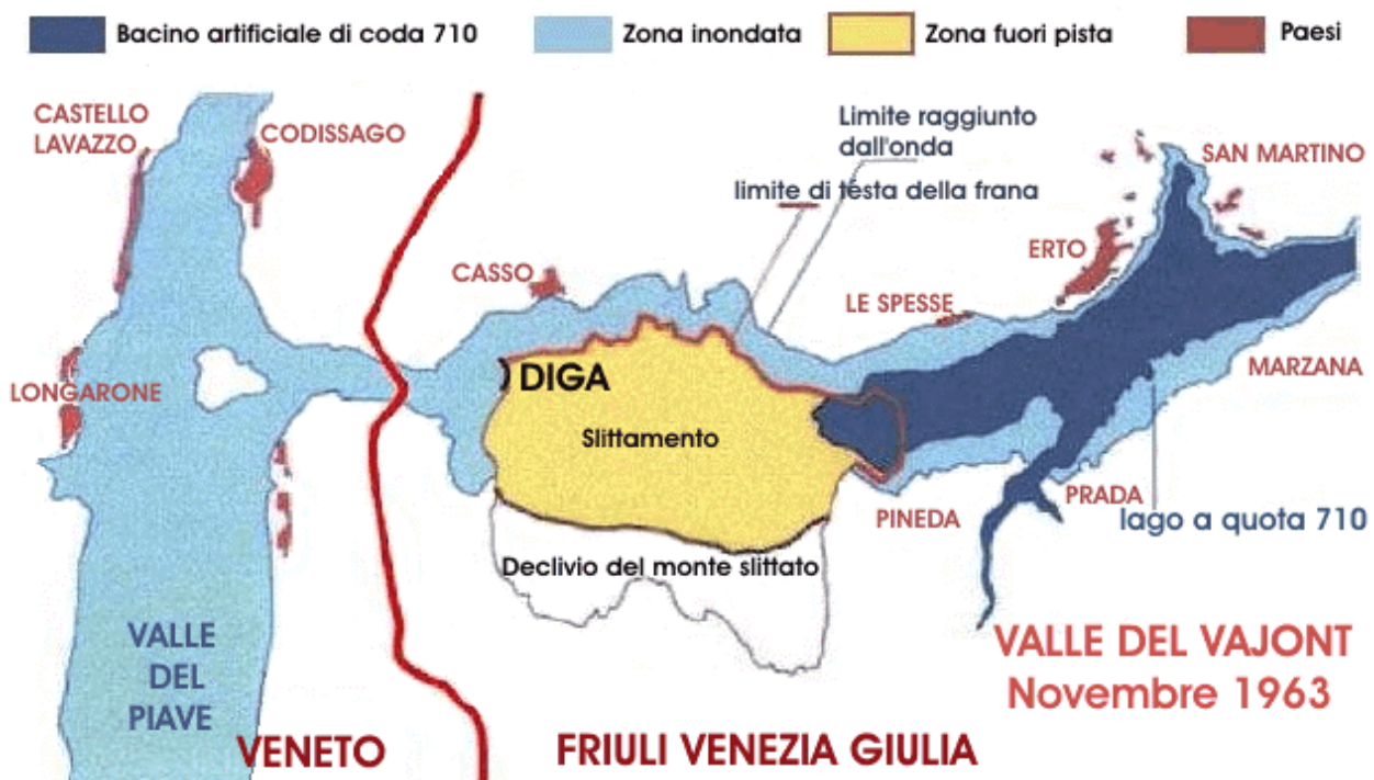
Fig. 1 - Planimetria della zona della diga del Vajont. Oggi l'acqua è scesa alla quota di 632 metri; la montagna si è stabilizzata. L'invaso è usato come scarico di fondo per mantenere il livello dell'ac-
